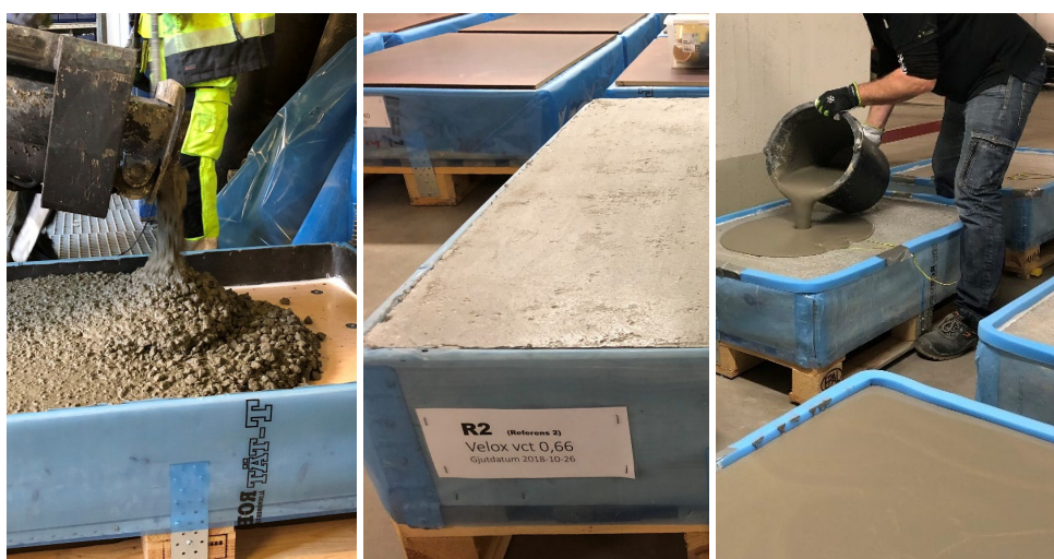
Figur 6. Tillverkning av provkroppar till undersökningen: gjutning (vänster), lagring inkl. själv- eller diffusionsuttorkning (mitten) samt avjämnning (höger)
