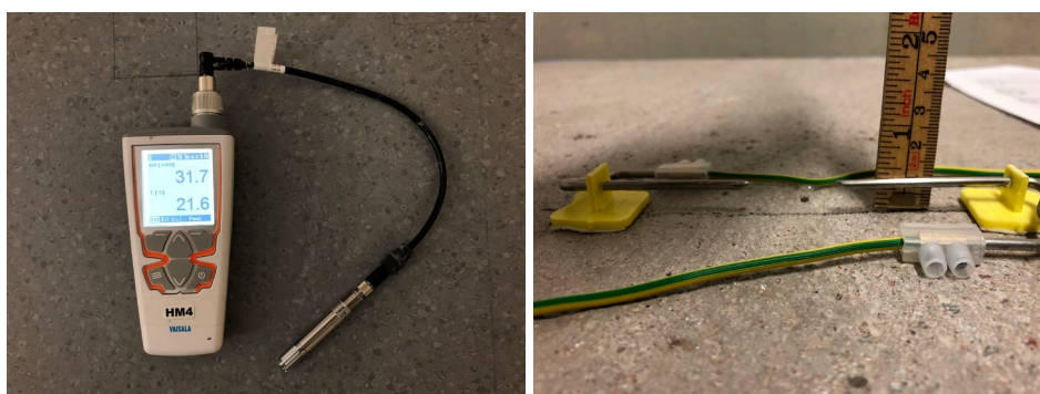
Figur 7. Givare för avläsning av fuktnivå, Vaisala HMP40S för RF i betong (vänster) samt resistiv givare som gjöts in i avjämningen för fuktnivåindikation (höger).
