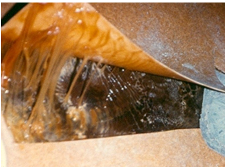
Figur 1. Nedbrytning av lim genom alkalisk hydrolys som resulterat i förtvålning.
